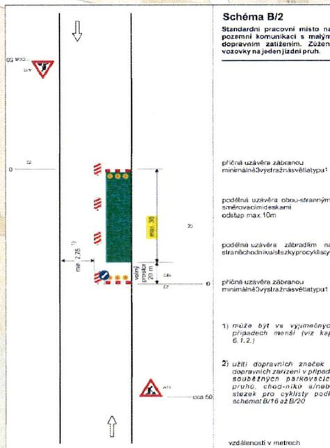
vzhledem ke stávajícím sítím ve vozovce nelze provést plánovaný protlak pod silnicí III/32329 pro pokládku el. kabelu NN - dané místo bude překopáno po polovinách, zůstane průjezdné jedním jízdním pruhem
